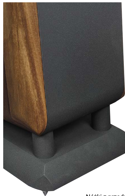
Nóżki z przodu są dwa razy wyższe niż z tyłu, co tworzy swobodniejsze ujęcie dla fal niskich częstotliwości i pochyla obudowę do tyłu.
